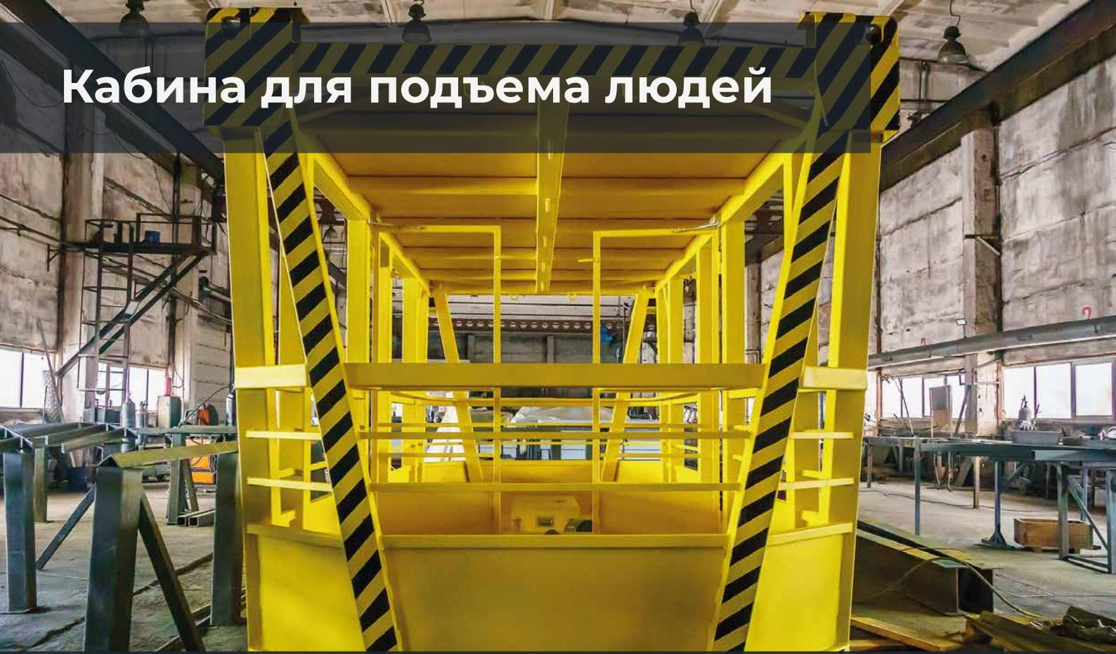
В производстве кабины применялись ключевые производственные мощности нашего предприятия: **лазерная и плазменная резка металла, гибка, сварочные работы**. Последний этап - **антикоррозийная защита и покраска с нанесением сигнальных линий и маркировки**.
