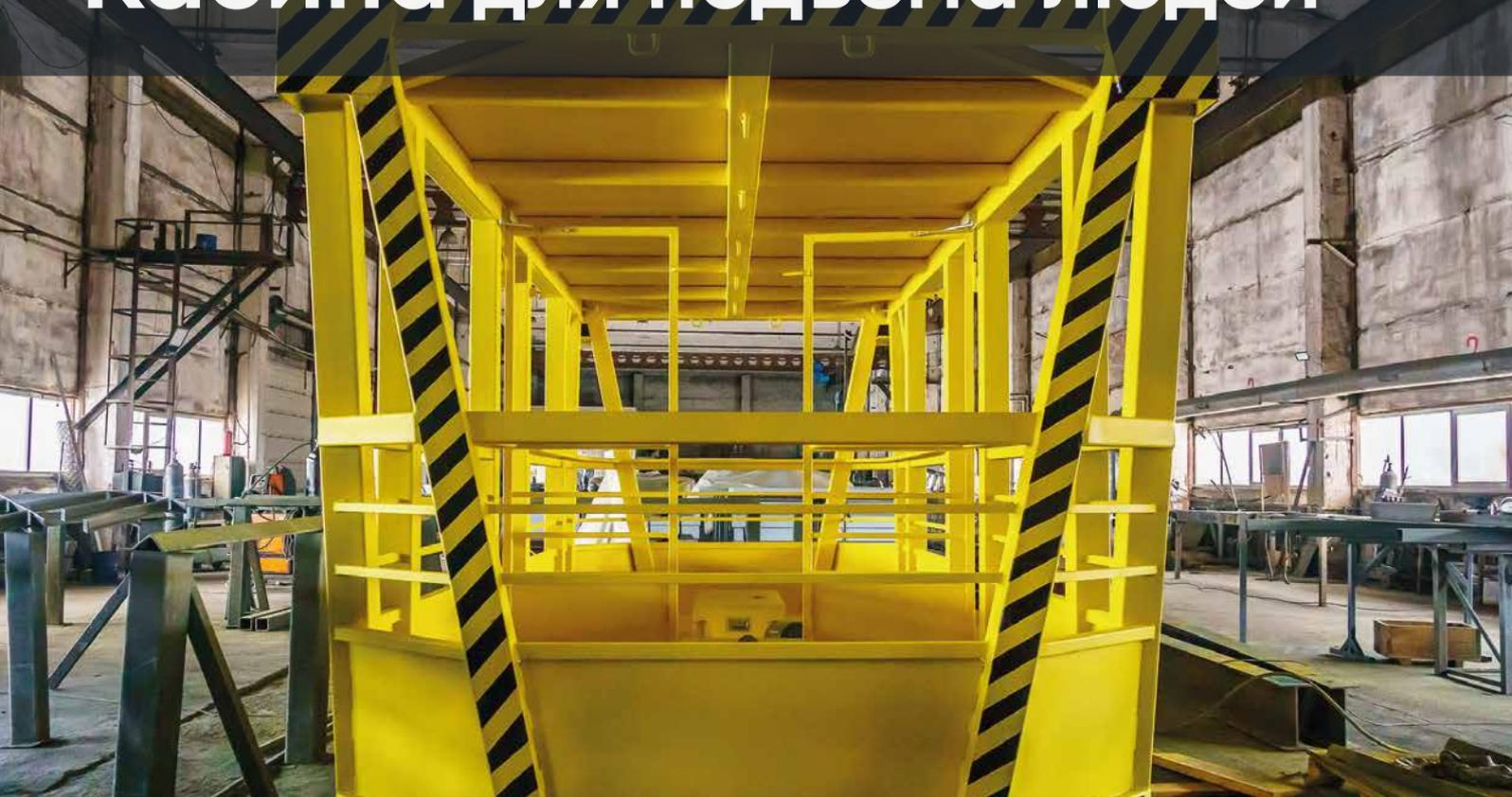
В производстве кабины применялись ключевые производственные мощности нашего предприятия: лазерная и плазменная резка металла, гибка, сварочные работы. Последний этап – антикоррозийная защита и покраска с нанесением сигнальных линий и маркировки.
